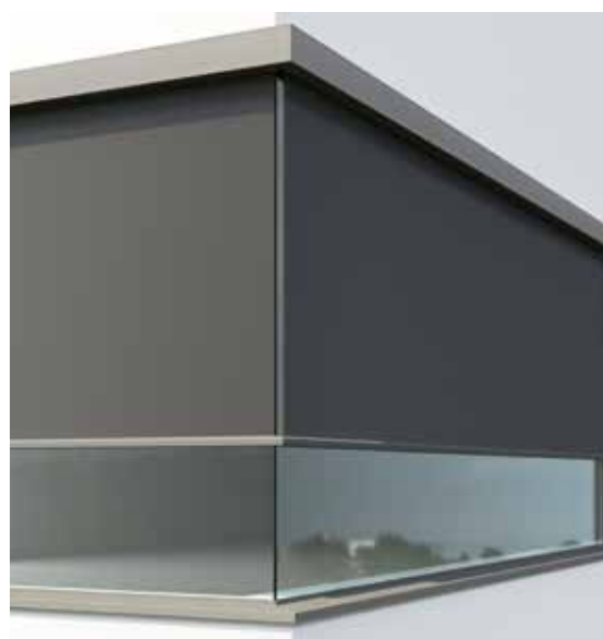
Die lichte Gewebeöffnung übers Eck ist nur ca. 40 mm breit. Eingeschränkte Windstabilität.
